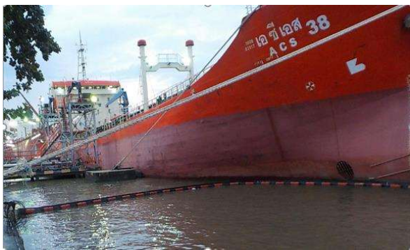
รูปที่ 2-5 ทุ่นกักน้ำมัน (Boom) อุปกรณ์ป้องกันการแพร่กระจาย กรณีเกิดการหกรั่วไหล
