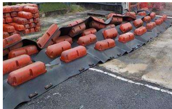
รูปที่ 2-5 ทุ่นกักน้ำมัน (Boom) อุปกรณ์ป้องกันการแพร่กระจาย กรณีเกิดการหกรั่วไหล
