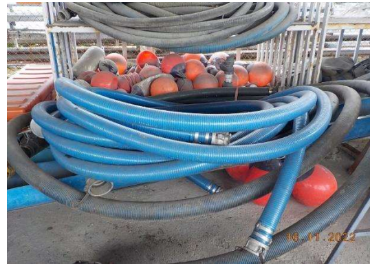
รูปที่ 2-8 อุปกรณ์สำหรับกำจัดครบน้ำมัน กรณีเกิดการหกรั่วไหล
