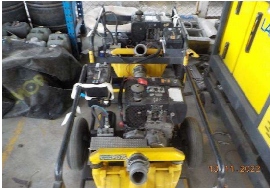
รูปที่ 2-8 อุปกรณ์สำหรับกำจัดครบน้ำมัน กรณีเกิดการหกรั่วไหล
